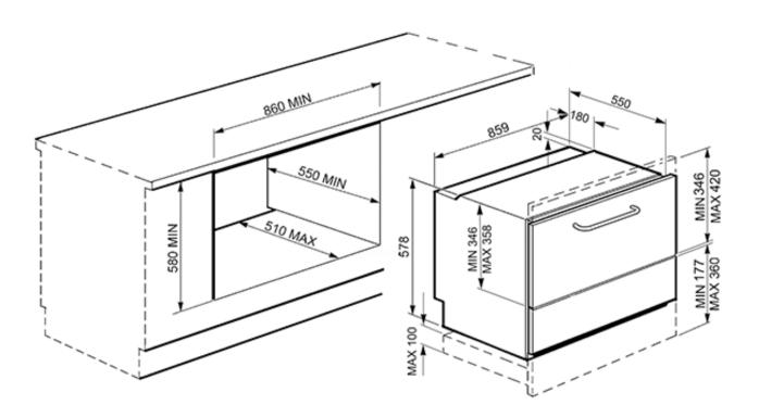
attenzione: dimensioni riferite ad installazione con pannelli di spessore 20 mm. Per pannelli di spessore diverso, consultare il manuale di installazione completo.
